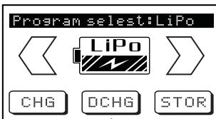
**A noter:** Après enregistrement de la capacité, le chargeur règle automatiquement le courant de charge à 1 C – un accu de 2000 mAh se chargera donc à 2 A. Si l'acco accepte une charge plus élevée, vous pouvez augmenter le courant de charge CURR.
