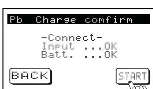
Nach Anschluss des Akkus an das Ladegerät und Drücken der **START** Taste wird der Akku vom Ladegerät überprüft, ist alles in Ordnung zeigt das Display **OK**.
