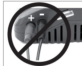
**⚠️ WARNUNG:** verwenden Sie nur Akkus mit XH-Balancerstecker. Versuchen Sie nie, Balancerstecker anderer Typen direkt mit dem Ladegerät zu verbinden! **Der Stecker oder das Ladegerät kann dabei beschädigt werden oder schlimmer der Akku in Brand geraten oder explodieren!** Verwenden Sie gegebenenfalls ein geeignetes Adapterkabel.
