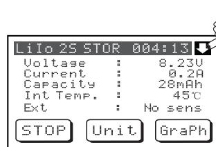
**Beachte:** das Ladegerät stellt den Ladestrom nach Eingabe der Kapazität automatisch auf 1C - ein 2000 mAh Akku wird mit 2 A geladen. Kann der Akku mit einer höheren Rate geladen werden, können Sie den Ladestrom CURR auch höher stellen.
